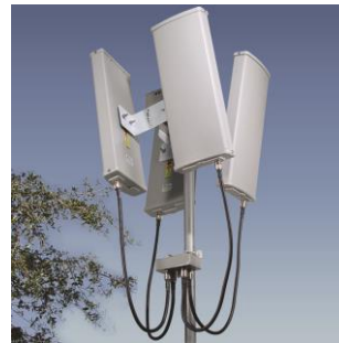
Omni Antenna Array
