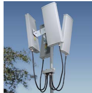
Omni Antenna Array
